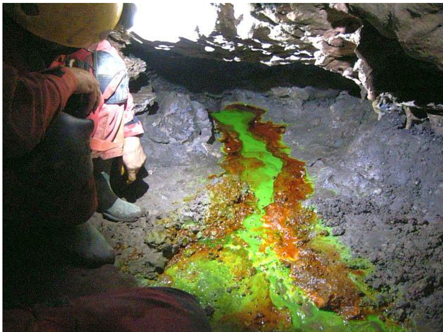
Figure 1 - Vue de l'injection du colorant dans l'Aven des Perles
