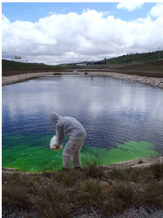
Photo 2 – injection de 6kg de fluorescéine dans le trop plein du bassin A24
