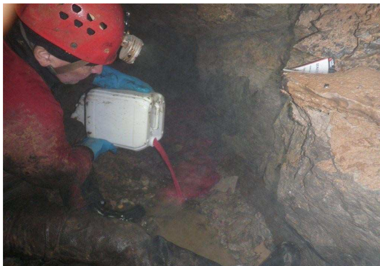
Photo 6 – injection, le 05/03/2017, de 0.2 kg de sulforhodamine B dans l'aven du Terry
