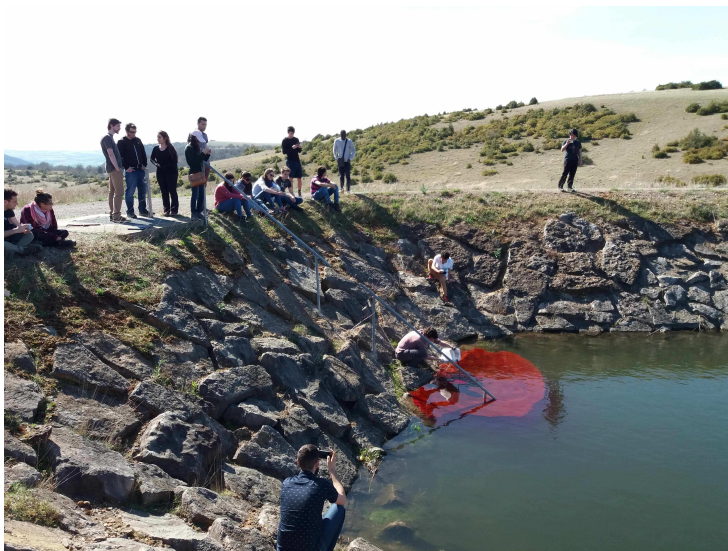
Photo 8 - injection, le 30/03/2017, de 0.3 kg de sulforhodamine B dans le bassin A30
