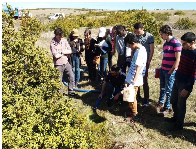
Photo 7 – injection le 30/03/2017 de 1.5Kg de Fluorescéine (en présence des étudiants de Jussieu)
