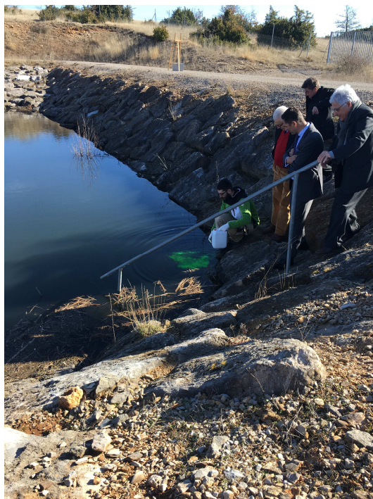
Photo 5 – injection, le 22/02/2017, de 1.5kg de fluorescéine à l'entrée du trop-plein du bassin A34 (en présence du Préfet de l'Aveyron)
