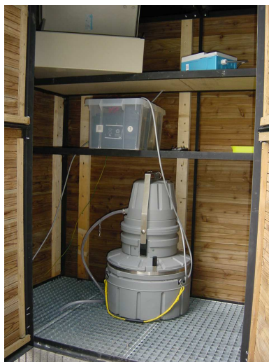
Photo 7 – Préleveur automatique à la source du Durzon
