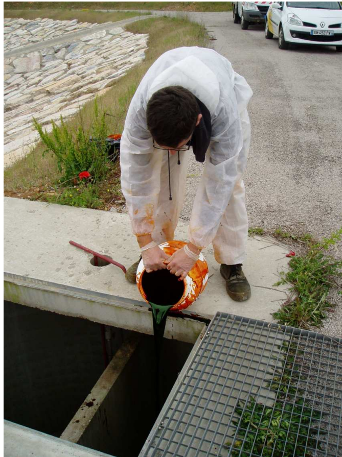
Photo 6 – injection de 15 kg de fluorescéine dans le trop plein du bassin A37
