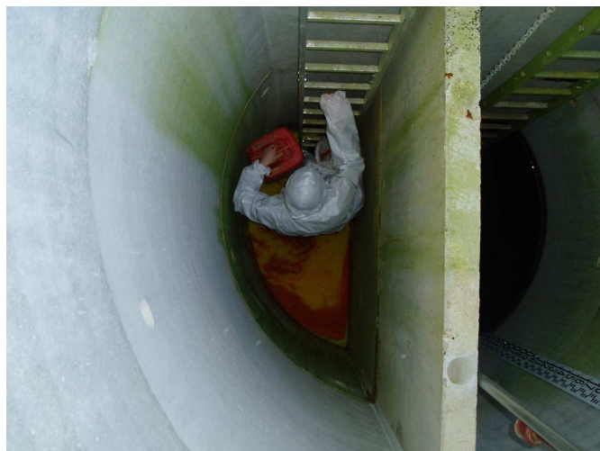
Photo 4 – injection de 6kg de fluorescéine dans le trop plein du bassin A33
