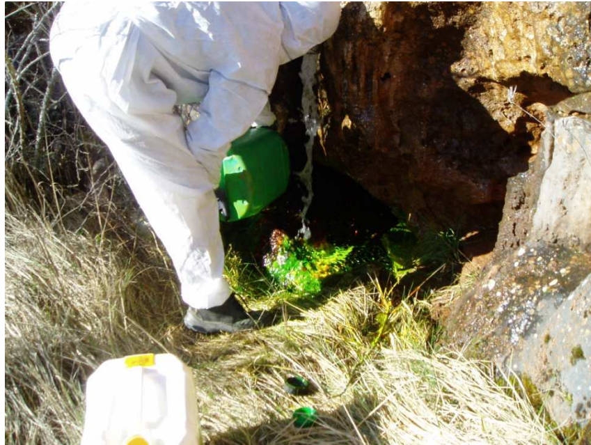
Photo 5 – injection de 16 kg de fluorescéine dans l'aven en aval du trop plein du bassin A44
