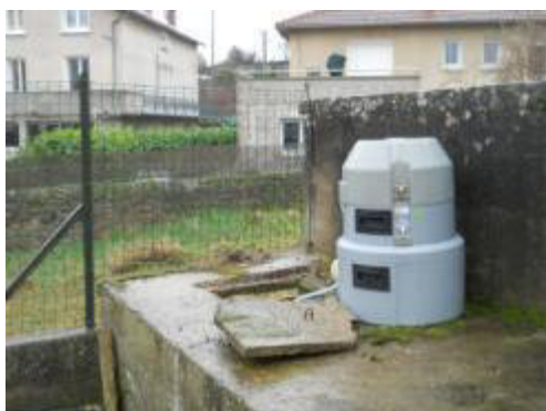
Préleveur automatique – source de la Mère de Dieu
