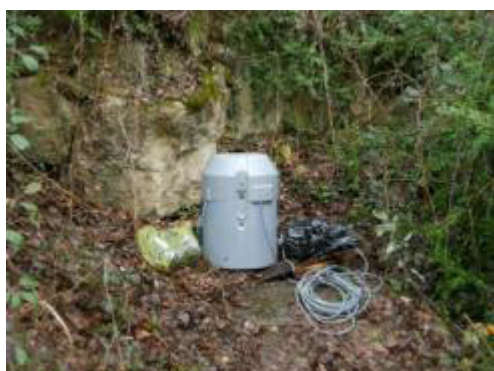
Préleveur automatique – source de Fontliane
