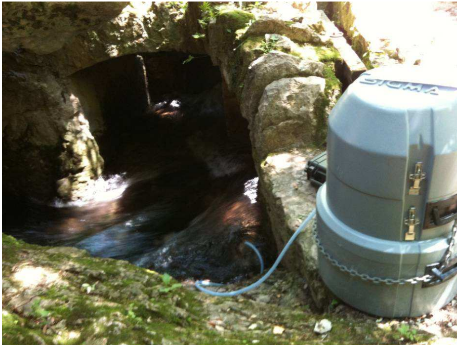
Photo 5 : Préleveur automatique installé à la résurgence de la Foux de la Vis
