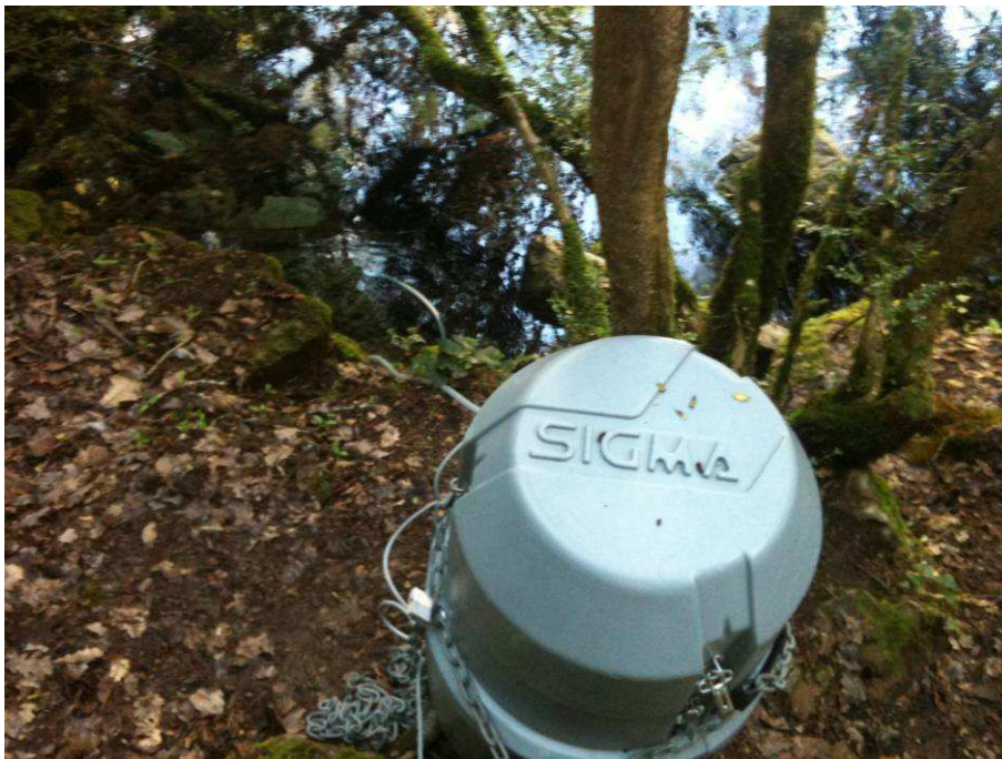
Photo 2 : Préleveur automatique installé à la source du Durzon
