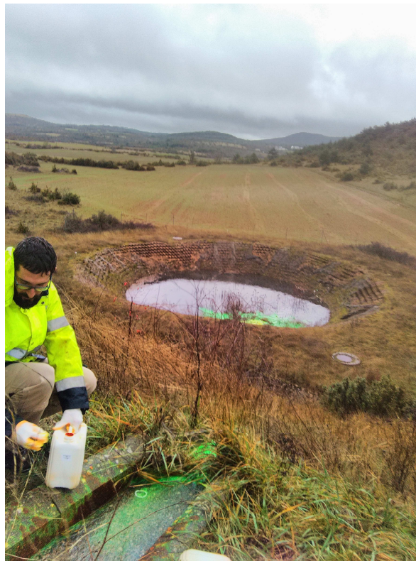
Photo 4 – injection, le 24/11/2016, de 15 kg de fluorescéine
