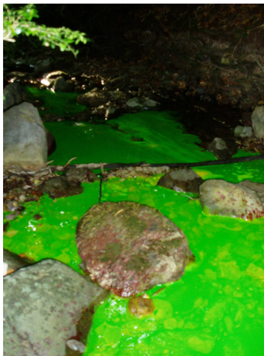
Injection de la fluorescéine au niveau de la perte
