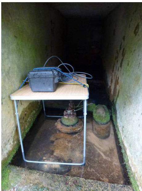
Figure 13 : Installation du fluorimètre au niveau de la source Gloriette
