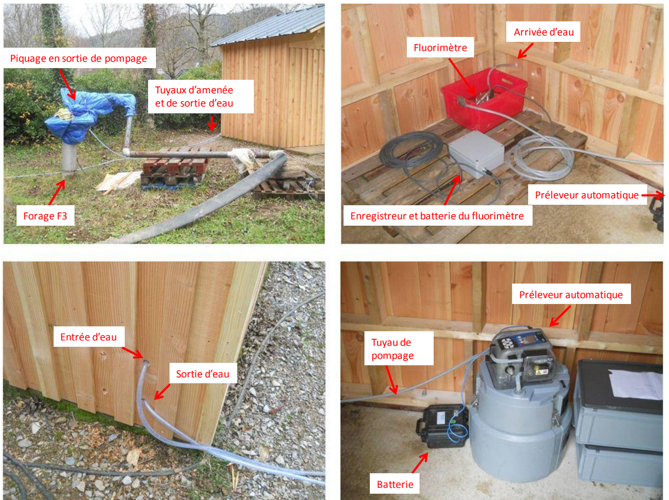
Figure 15 : Installation du matériel de suivi sur le forage F3
