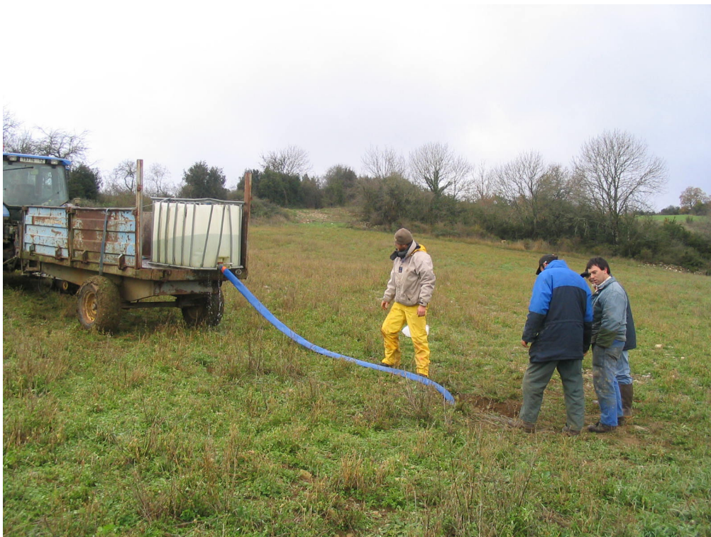
Photo 2 : Injection de KI dans l'Aven de la Combe (1)
