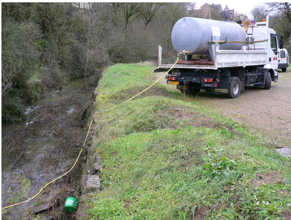
Photo 5 : Injection de Sulforhodamine dans le Ravin de Merd Erie (1)
