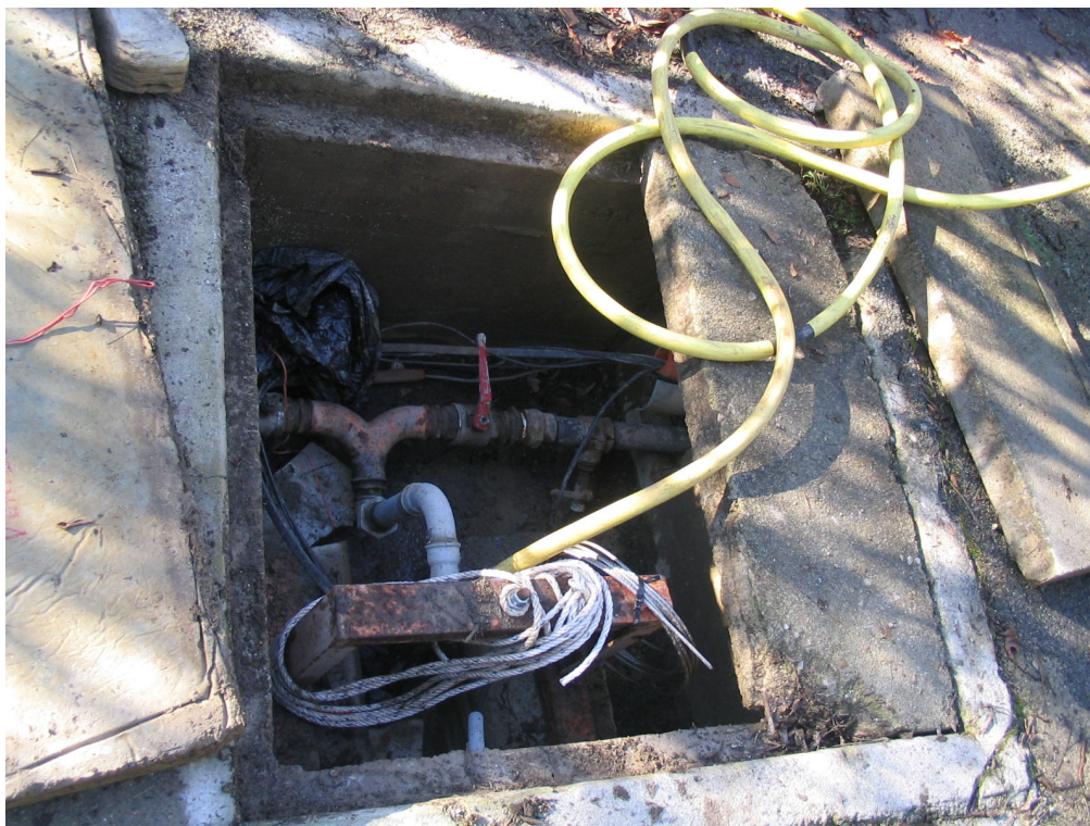
Photo 8 : Injection d'Uranine dans le forage de M. Malleviale (2)
