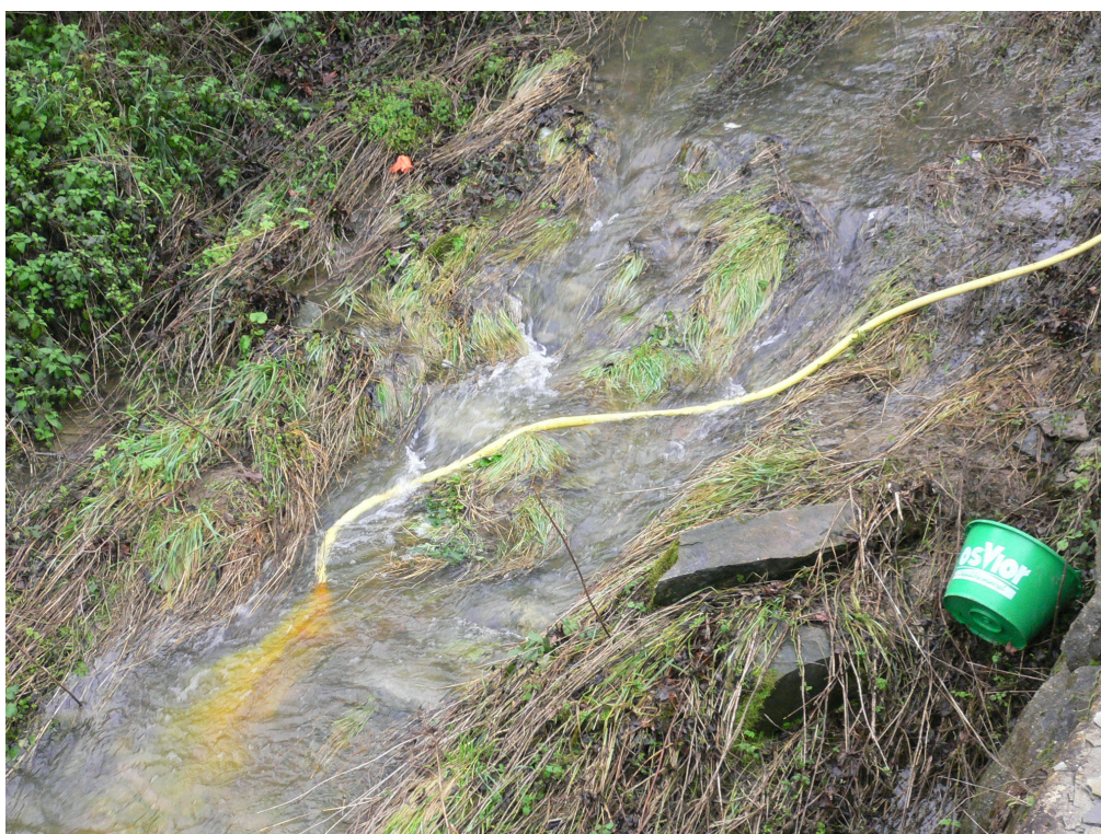
Photo 6 : Injection de Sulforhodamine dans le Ravin de Merd Erie (2)
