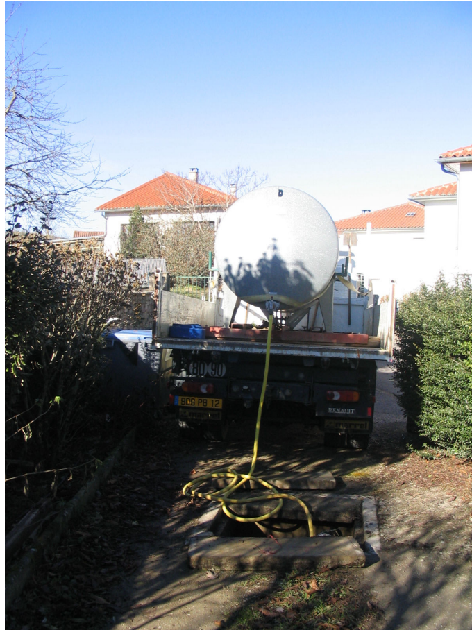
Photo 7 : Injection d'Uranine dans le forage de M. Malleviale (1)
