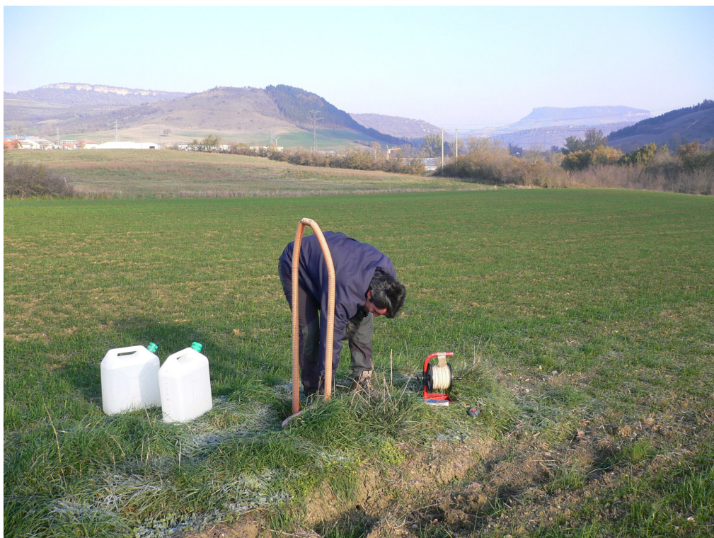
Photo 4 : Injection de NaCl dans le forage de Mme Couderc
