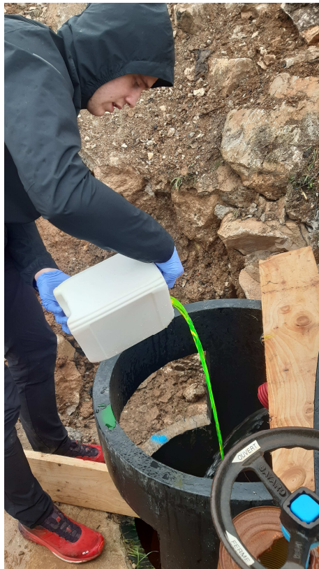
Figure 3 : Injection de 1.5 Kg de Fluorescéine le 22/01/2021 à 13h10Tu
