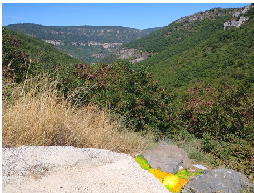
Figure 4 : injection de 0.3 Kg de fluorescéine le 25/08/2021
