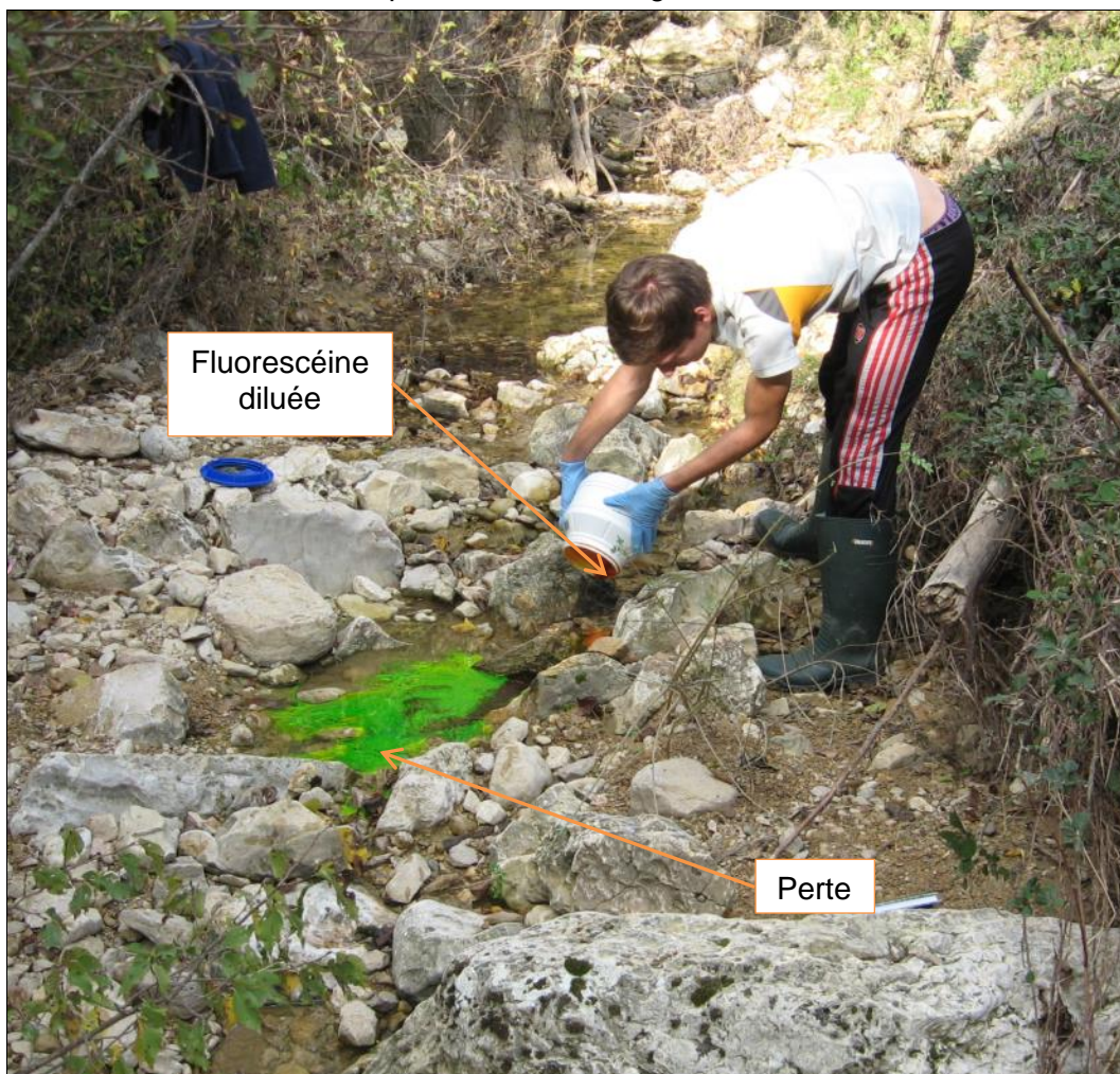
Figure 2 : Injection de fluorescéine dans la perte Paloc
