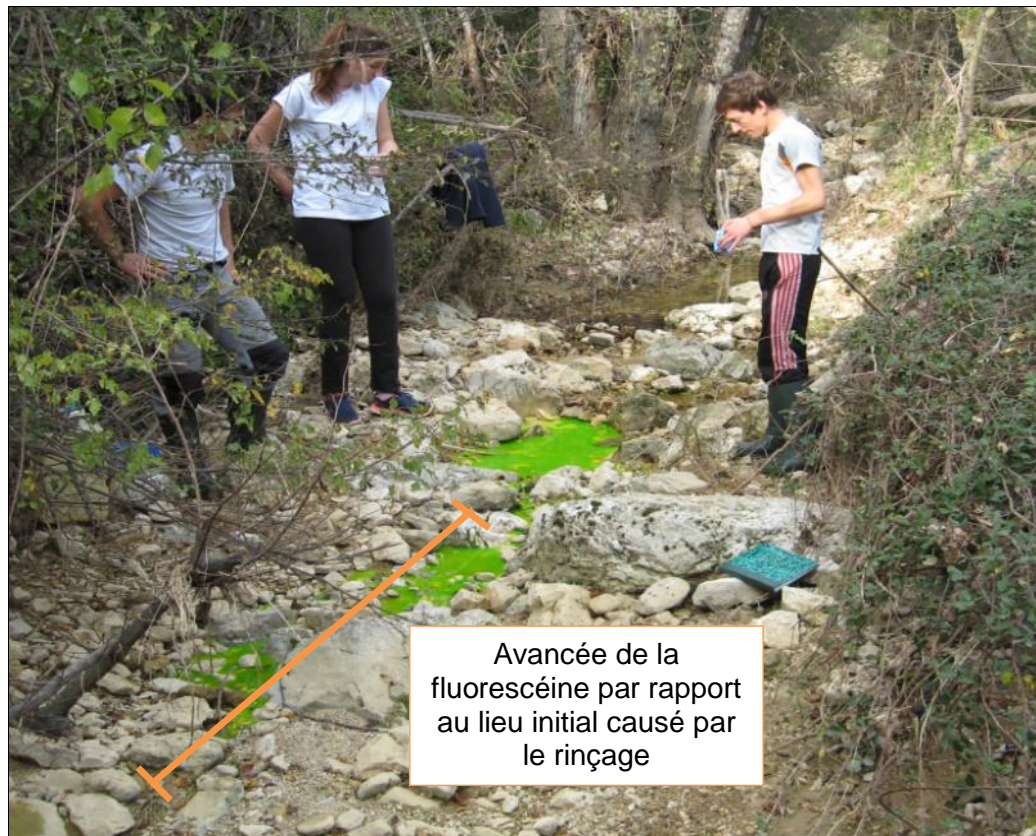
Figure 4 : Avancée de la fluorescéine dans le ruisseau d'Aigues-Vives
