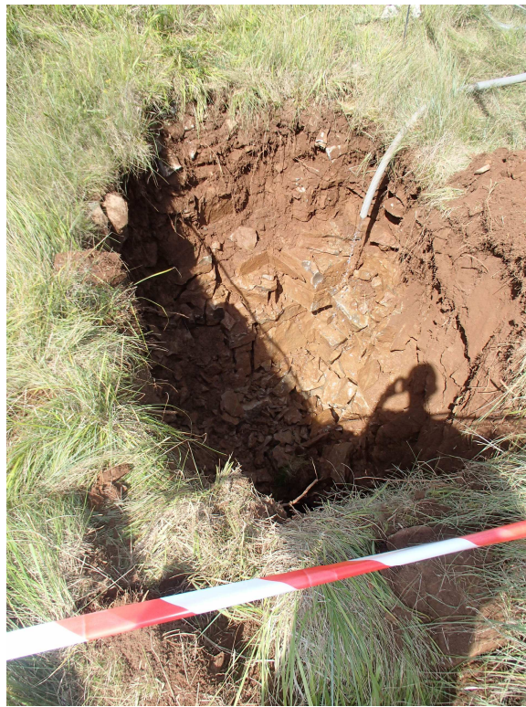
Test d'infiltration le 06/08/2014, 700L en 0 s, infiltration instantané
