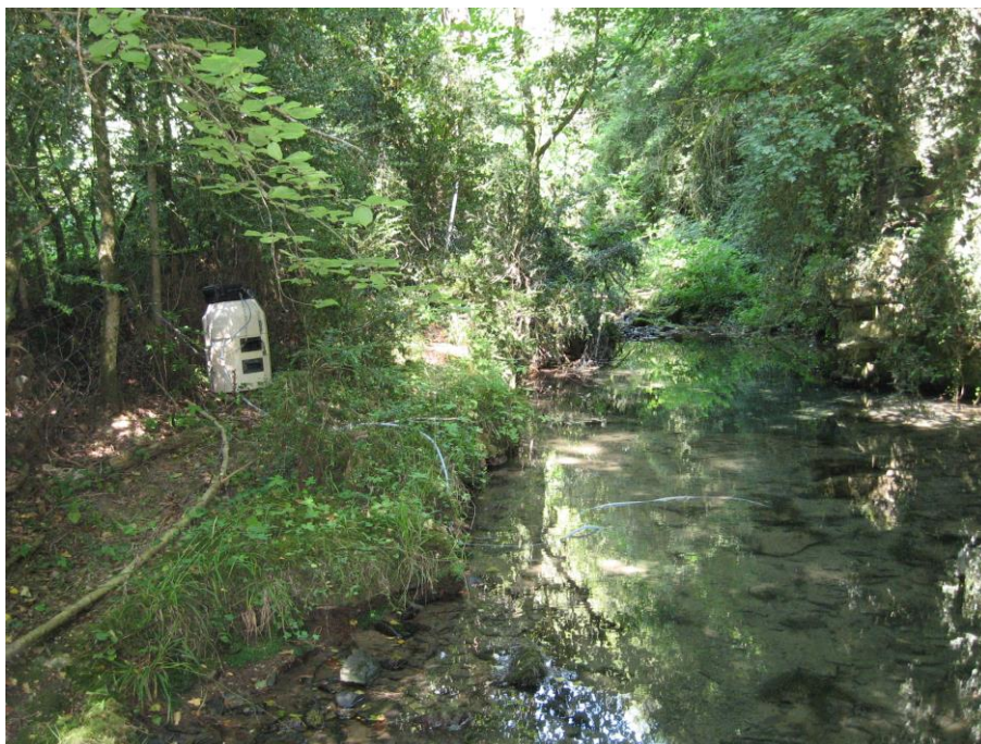
Photo 3 : Préleveur automatique à la source de la Grotte
