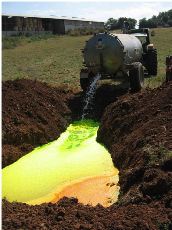
Photo 1 : Injection de fluorescéine dans la doline de Canta-Merlhe
