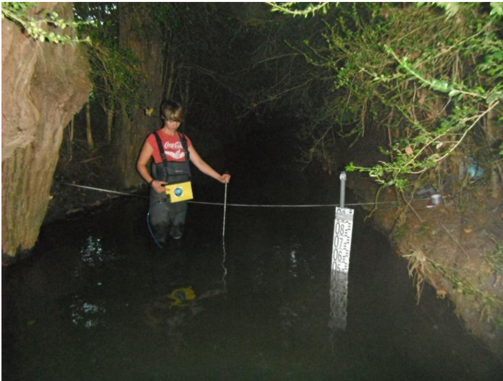
Photo 15 : Jaugeage au point Versols amont, avec échelle limnimétrique et sonde de niveau
