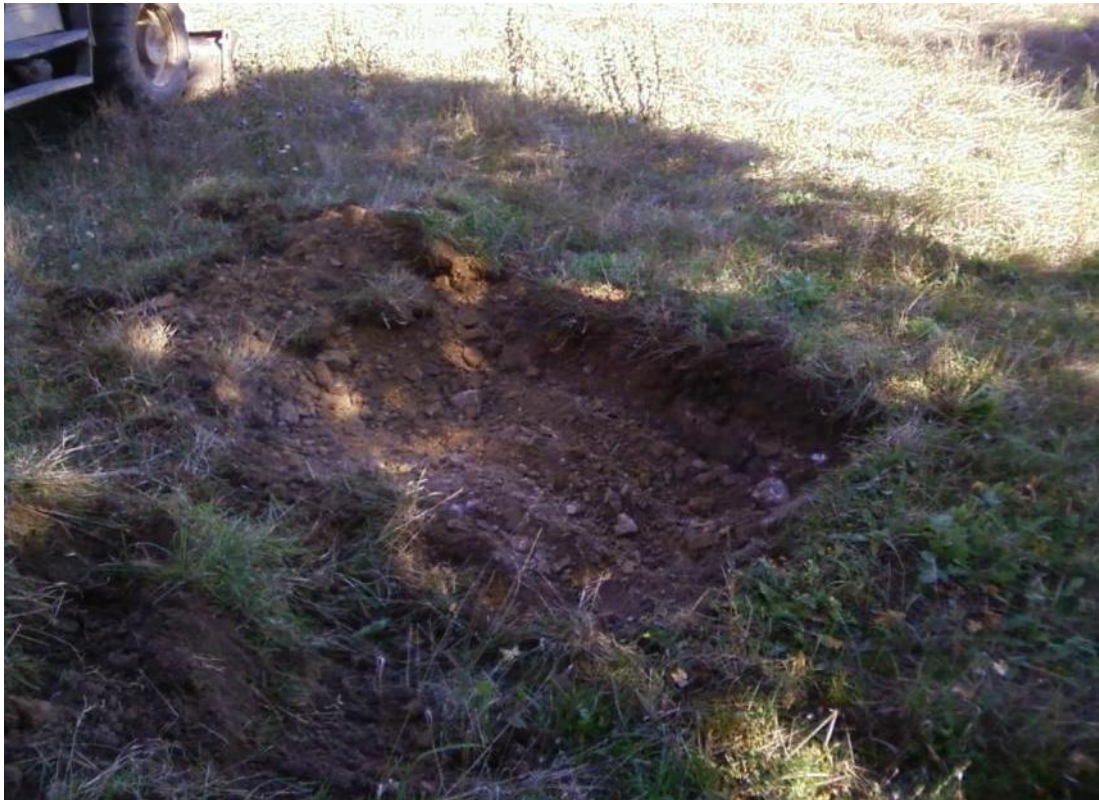
Photo 3 : Fosse F2' (arrêt du sondage car refus calcaire)
