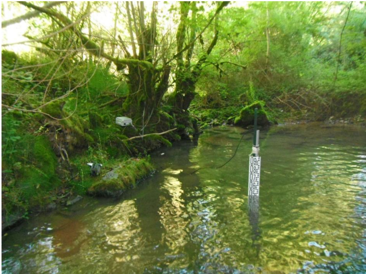
Photo 14 : Sonde de niveau et échelle limnimétrique au point Versols aval
