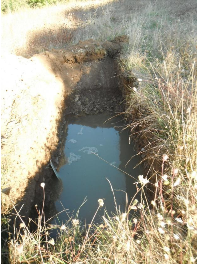
Photo 7 : Test d'infiltration à la fosse F3
