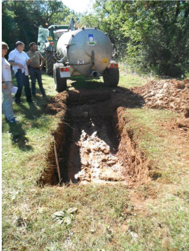
Photo 5 : Fosse F1 à la fin du test d'infiltration
