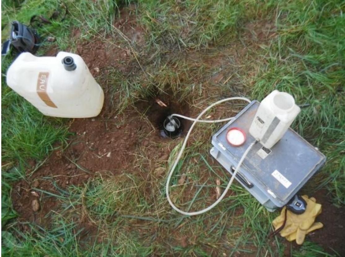
Photo 2 : Réalisation d'un test Porchet (perméamètre)
