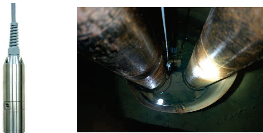
Fig. 8. Photos de la sonde du fluorimètre installée dans le puits AEP de Lestang
