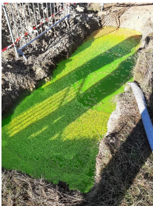
Figure 11 : Illustrations de l'opération d'injection du traceur dans le bassin d'infiltration
