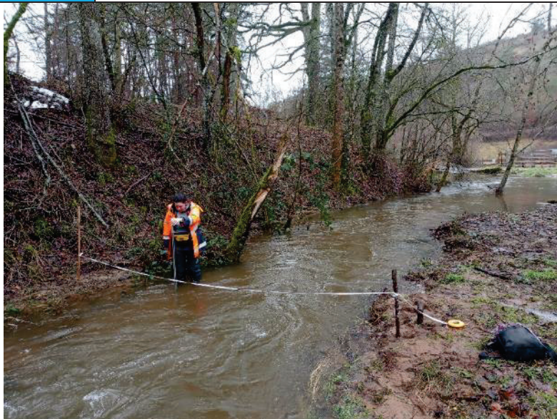
Figure 70 : Vue du jaugeage réalisé sur la Muze (clichés Calligée 02/02/2021)
