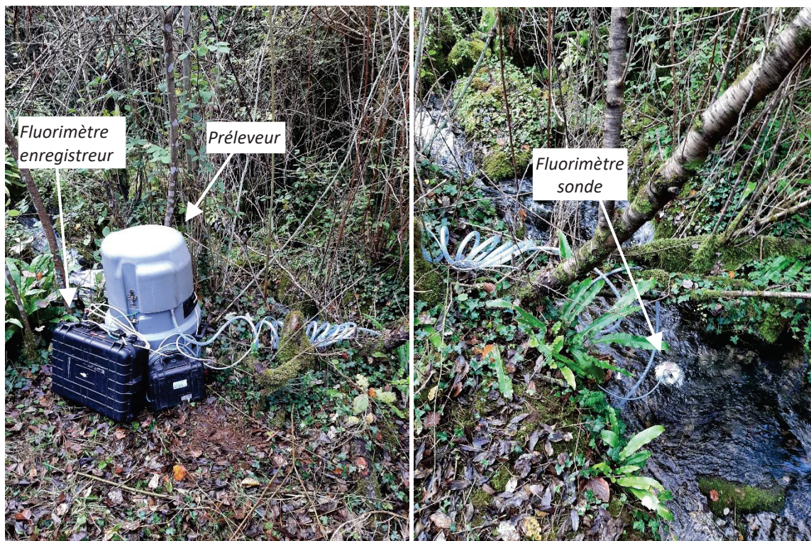
Figure 15 : Illustrations du matériel de suivi installé à la source du Moulin de Laumet
