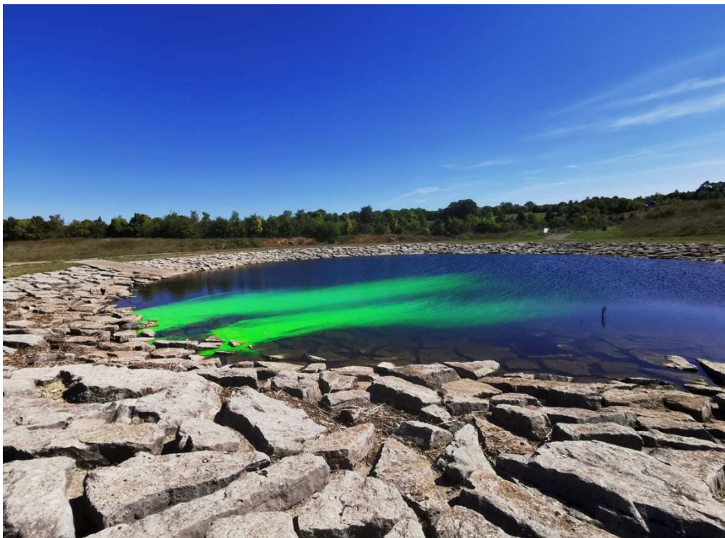
Figure 9- injection, le 19/09/2022 à 12h00 de 9 kg de fluorescéine
