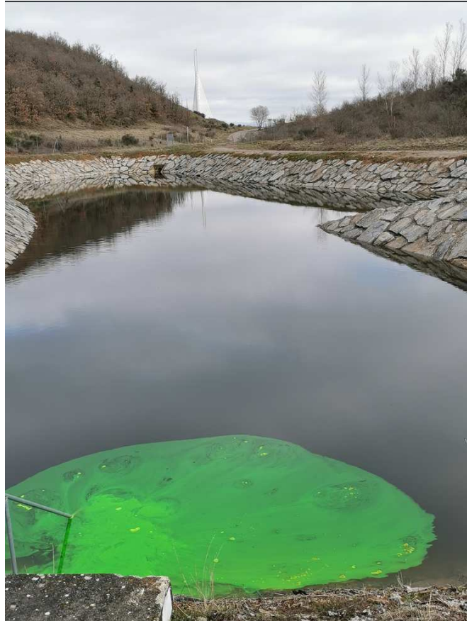
Figure 6- injection, le 24/03/2023, de 250 g de fluorescéine
