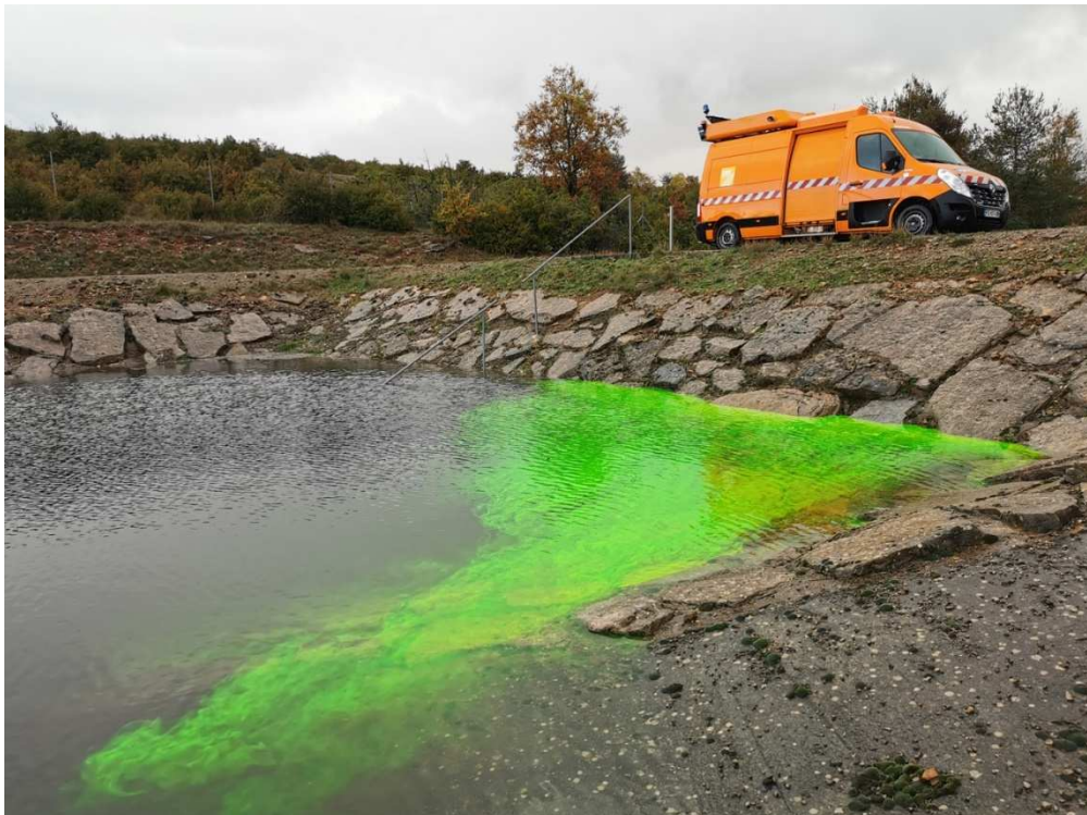
Figure 8- injection, le 23/11/2022 d'environ 450g de fluorescéine
