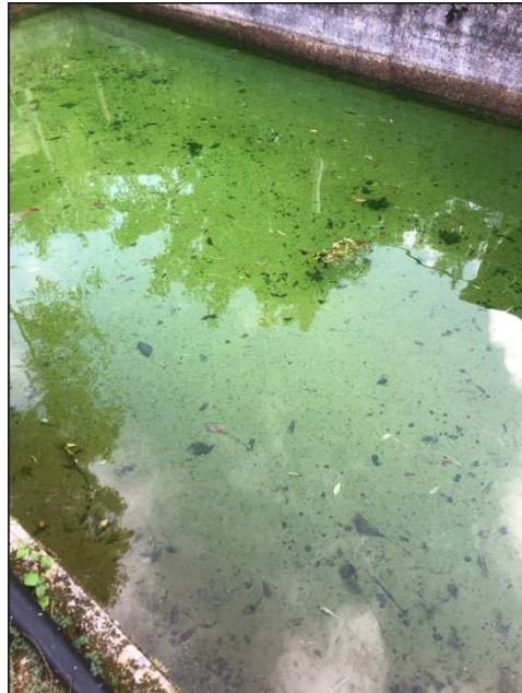
Figure 12 - Restitution visible de la fluorescéine à la source du Moulin de Laumet
